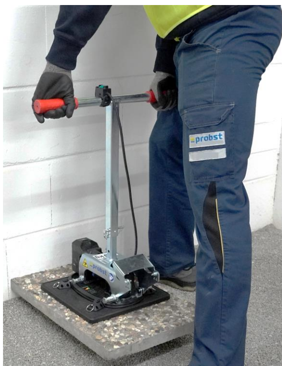
XS-JET-80-GRABO (58500018) avec FXAH-120-SOLO-Set (48500055)
